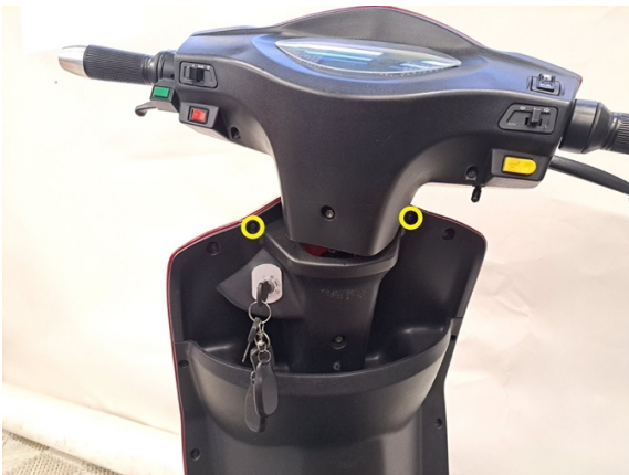
Irrota etupaneelin kiinnitysruuvit. (ristipäämeisseli ph2).
