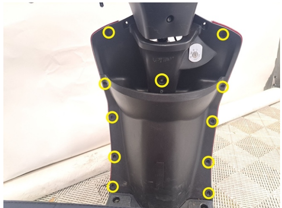
Irrota etukatteen kiinnitysruuvit (ristipäämeisseli ph2) ja kiinnityspultti. (hylsy 8 mm).
