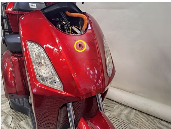
Irrota etukatteen kiinnityspultti. (hylsy 8 mm).
