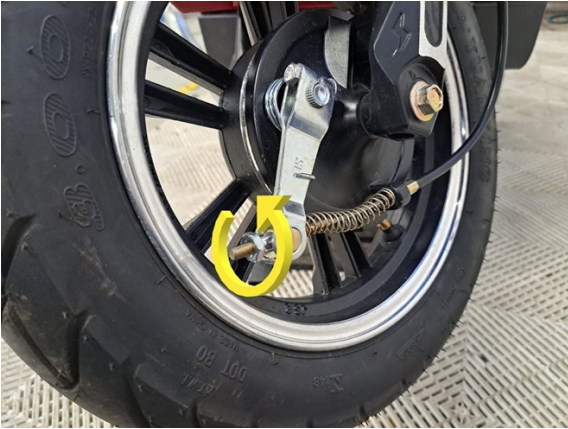
Löysää etujarrun säätömutteri (kiintoavain 14 mm) löysimmilleen.
